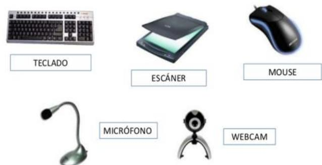
**Figura 4** Dispositivos que permiten ingresar datos al computador (PC)
